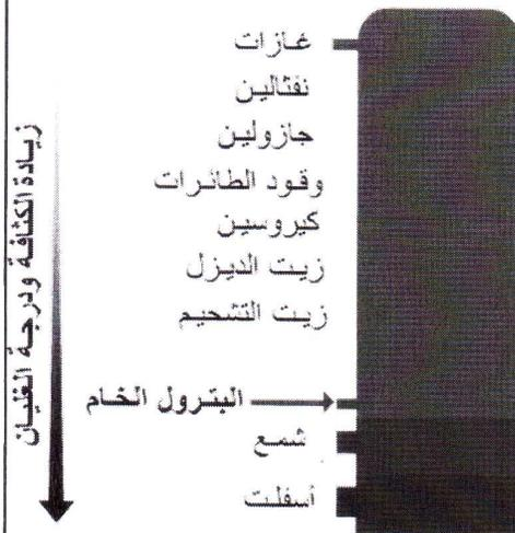
(د) الشكل المقابل يوضح جهاز فصل مكونات البترول.
